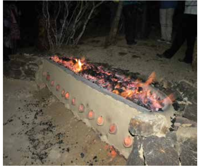
உரு 1.22 இரும்பை உருக்குவதற்குப் பயன்படுத்தப்பட்ட சூளை
