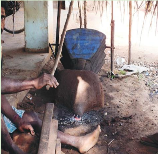
உரு 1.10 இடது: இரும்பை உருக்குவதற்குப் பயன்படுத்தப்படும் சூளையுடன் கூடிய ஊதுளைக் கருவி வலது: அகழ்வுகளின் போது கண்டெடுக்கப்பட்ட புராதன கால இரும்பு ஆணிகள்
